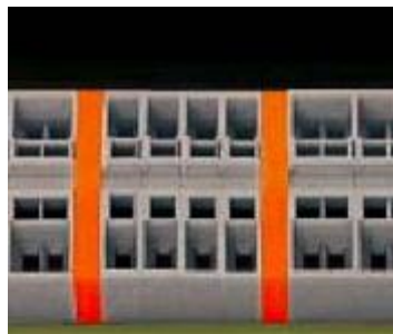
Группировка с помощью промежуточных пластин
